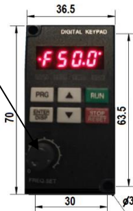
TYP A Potenciometer POT na externom panely
