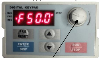
TYP A Potenciometer POT na externom panely
